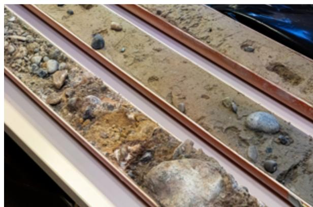
*Die Bohrkern aus Tiefbohrungen werden gewaschen, fotografiert und anschliessend für Untersuchungen im Labor luftdicht verpackt*
