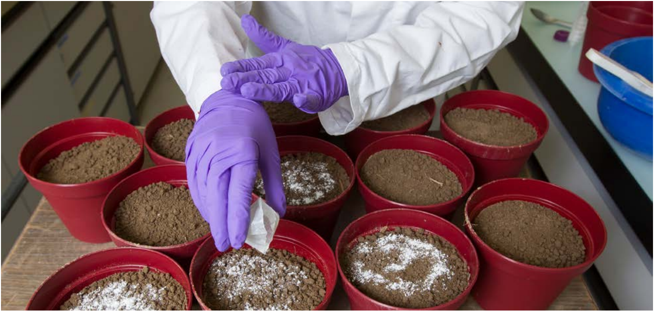
Test von aus Klärschlamm gewonnenem Phosphor als Dünger
