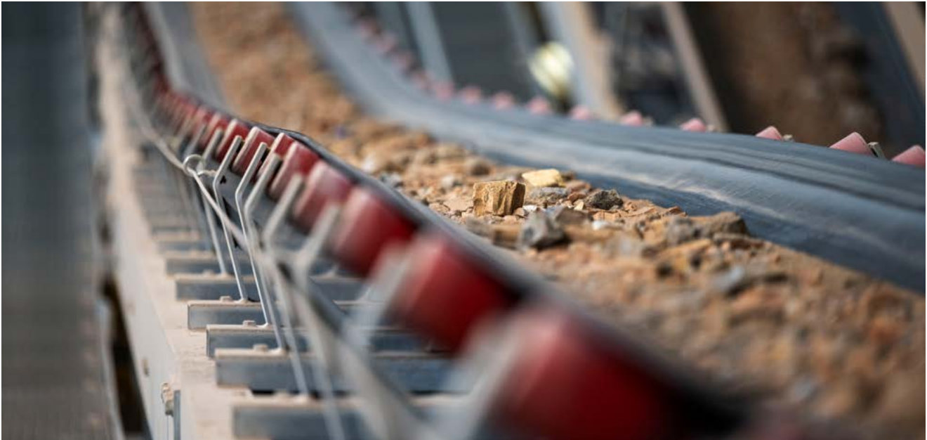
Recycling-Baumaterial im Aufbereitungszentrum für Bauabfälle in Oberglatt
