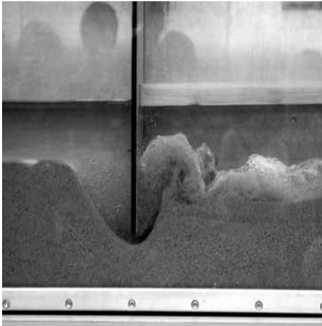
Der hydraulische Grundbruch: Die Schutzwand gegen aufsteigendes Grundwasser muss tief verankert werden, sonst strömt viel Wasser in Baugruben.
