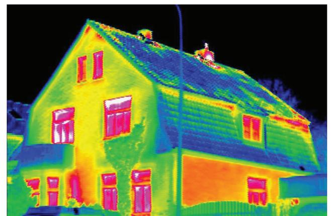
Wärmebilder zeigen, wie hoch die Aussentemperatur am Bauwerk ist. Sie machen sichtbar, wo die Wärmeverluste auftreten. Foto: Energie Beratung Matteredne, Eckental (D)
