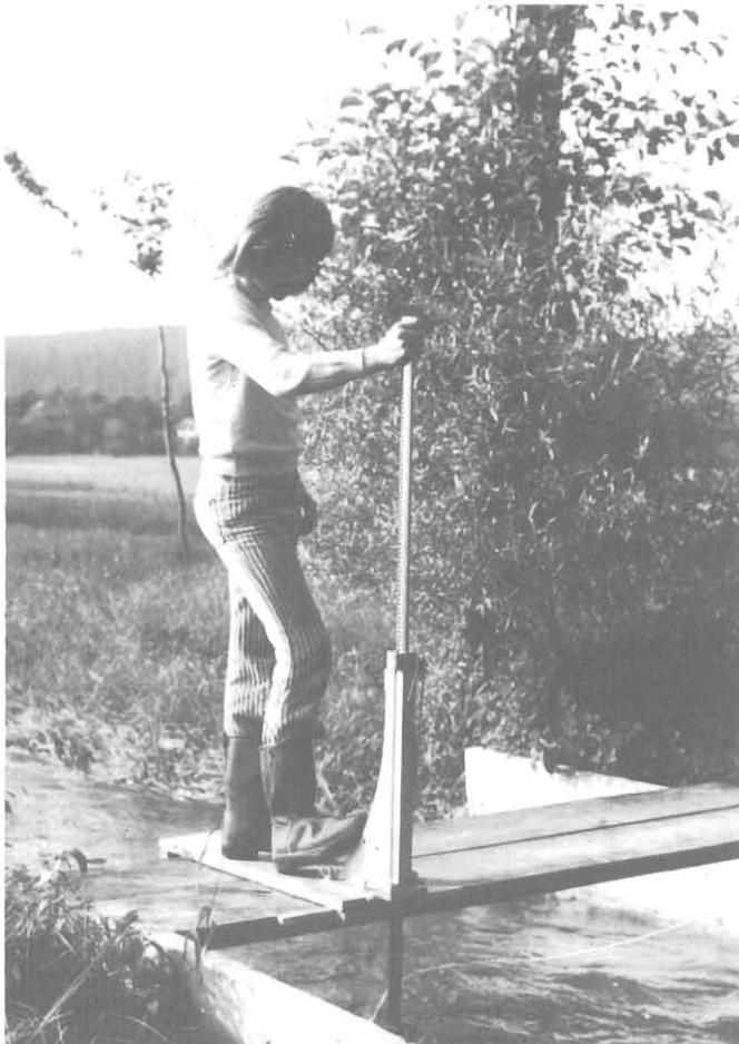
Abb. 24 Abflussmessung mit hydrometrischem Flügel, an einem als Messkanal ausgebauten Wässergraben. Sichtbar sind die Flügelstange, der Flügelbock und das Kabel (unter Messbrücke) zur Signalübermittlung. Der Messflügel selbst ist im Wasser.
