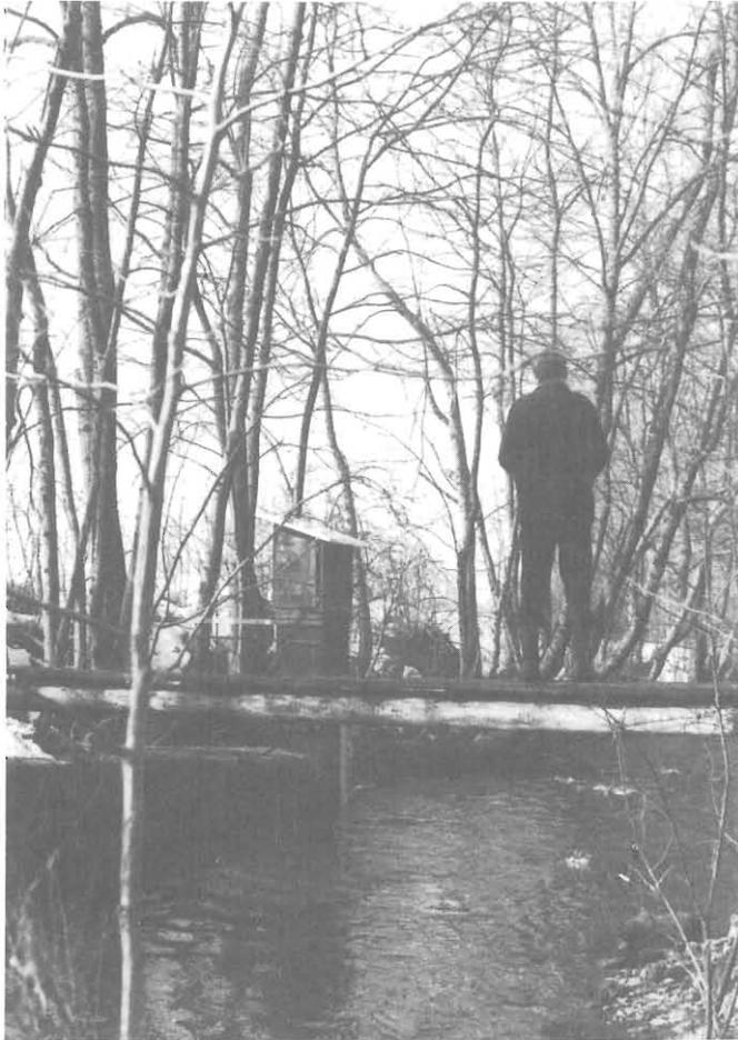
Abb. 23 Abflusstation Roth-St.Urban. Vorn die Messbrücke für die Flügelmessungen. In der Bildmitte die Kabine mit den Messgeräten, aufgesetzt auf dem Schwimmerschacht mit Pegelplatte.
