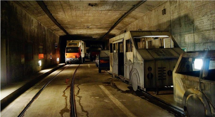
*Abbildung 2:* Eigentlicher Brandherd. Die beiden Stahldummies vorne rechts, können durch kontrolliert entweichendes Gas in Vollbrand gesetzt werden. Dadurch können Brandsituationen im realen Umfeld, bei Temperaturen von mehreren 100°C trainiert werden.
