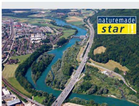
**Laufkraftwerk Ruppoldingen** der Alpiq Hydro Aare AG, [www.alpiq.com](http://www.alpiq.com), installierte Leistung: 23 MW / Jährlicher Ertrag: ca. 112 GWh. Foto Alpiq Hydro Aare AG
