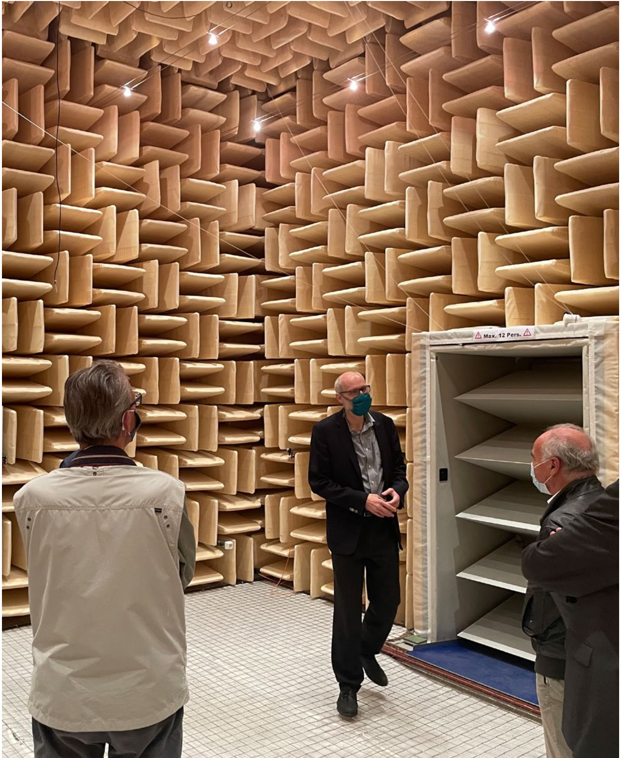
Abb. 3: Das Akustiklabor ist mit schallabsorbierenden Wänden ausgerüstet, um Kalibrierungen und Eichungen nicht durch Schallreflexionen zu beeinflussen.
