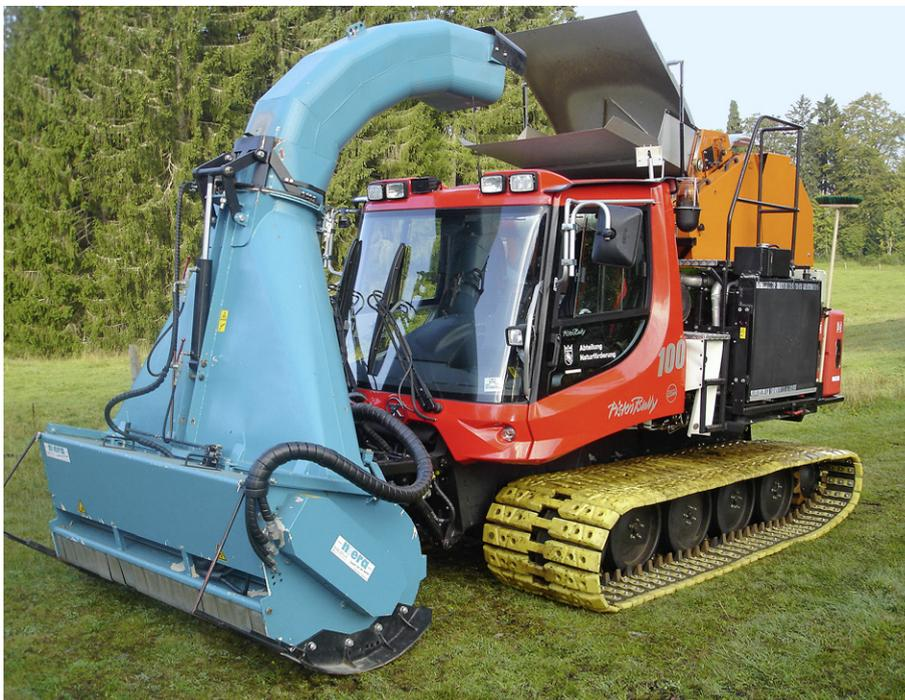
Abbildung 23: Die neue Schilfmähmaschine der ANF mit Mähwerk und Rundballenpresse.
