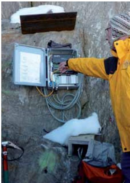
Auslesen der Temperaturdaten am PERMOS-Bohrloch am Gemsstock, UR, auf 2940 m ü. M.
