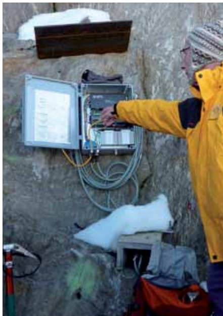
Lecture des données de température du forage de PERMOS au Gemsstock, UR, 2940 m.
