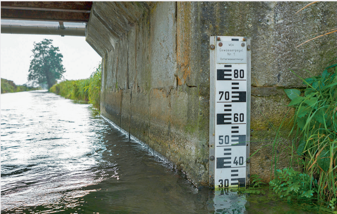
Fig. 8 Des limnimètres pour la mesure du niveau d'eau – comme cet exemple au bord de la rivière Urtenen près de Schalunen (canton BE) – servent entre autres à déterminer le débit résiduel minimal critique qui ne doit pas être dépassé pour des raisons écologiques. Ainsi, chaque agriculteur peut évaluer si les prélèvements d'eau pour l'irrigation agricole sont encore possibles. Ce système favorise également le contrôle social. (Photo: M. Zeh, AWA, Kt. Bern)
