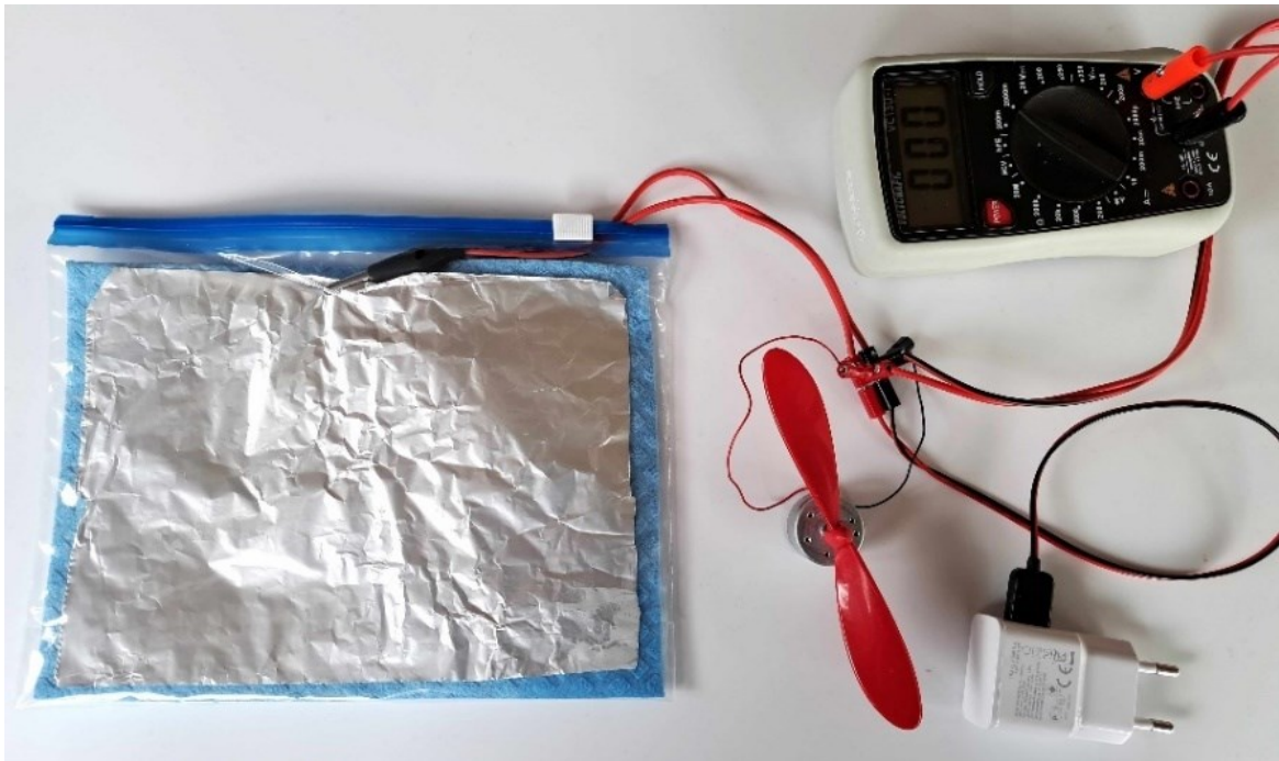
Abbildung: Aufbau und Anschlüsse des «Powerbags»: Das Multimeter (Einstellung =20V) kann immer angeschlossen bleiben, aber niemals gleichzeitig externe Spannung und der (empfindliche) Motor.
