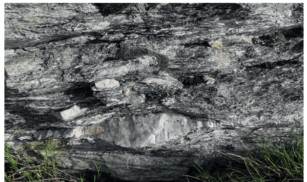
Abb. 11: Die Col-de-Chassoure-Formation ist vielgeschichtig, hier mit den typischen weissen Quarzgeröllen (SARTORI ET AL. 2017) und typischem Strahlungspegel von (510 +/- 7) cps, Koordinaten 631539 / 121079
