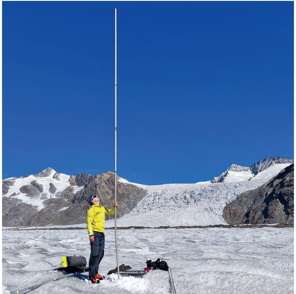
Abb. 2: Mess-Pegel zur Bestimmung der Schmelze. An dieser Stelle auf dem Konkordia-platz, inmitten des Grossen Aletsch-gletschers, sind im Sommer 2022 über 6 Meter Eis abgeschmolzen, wie durch Höhe der Stange illustriert wird.
