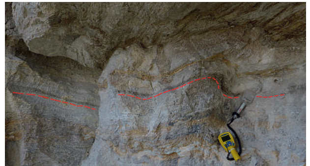
Abb. 18: Detail der Stelle TA5-5. Die Indikationen liegen im dunklen Band oberhalb der roten gestrichelten Linie. Der höchste Messwert liegt bei (15.5 +/- 0.1) kcps. Rechts unten ist der SEA Szintillationszähler mit der Graetz-2002-Sonde zu sehen. In den bräunlichen Bändern kommen gemäss FELDMANN (1986) Karbonate vor, die als Ankerit auftreten.
