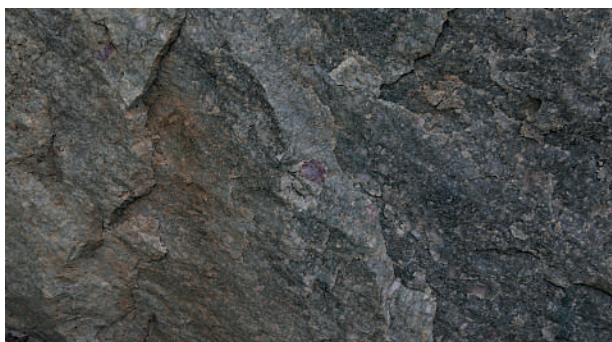
Abb. 12: Quarzit der Bruneggjoch-Formation mit charakteristischen violetten Quarzkiesel (SARTORI ET AL. 2017), Strahlungsrate (238 +/- 5) cps, Koordinaten 631035 / 121448. Bildbreite ca. 20 cm
