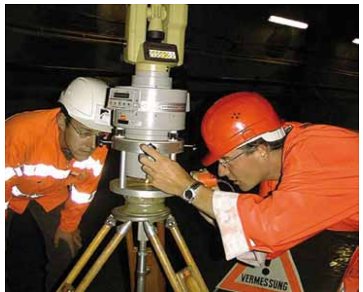
Abbildung 1: Vermessungskreisel der ETHZ.
