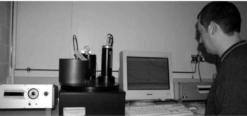
Das Lumineszenzgerät zur Altersbestimmung von Sedimenten: Das Instrument besteht aus einer schwachen radioaktiven Quelle, einer Stimulationseinheit und einem Photomultiplier. (Bild: Frank Preusser)
