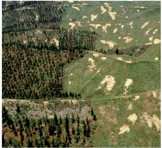
Deutlich sichtbare Wirkung von Wurzelwerk bei flachgründigen Rutschungen: Die Zahl und Grösse der Rutschungen in der nicht bewaldeten Fläche ist deutlich höher. (Foto: C. Phillips, Landcare Research, NZ)
