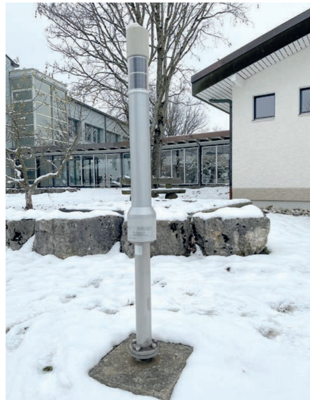
Abbildung 2: Messsonde des Typs GammaTracer XL2 der Firma Bertin GmbH. Die benötigte Energie für Messtechnik und Kommunikation wird über integrierte Solarpanels erzeugt. Bild: ENSI
