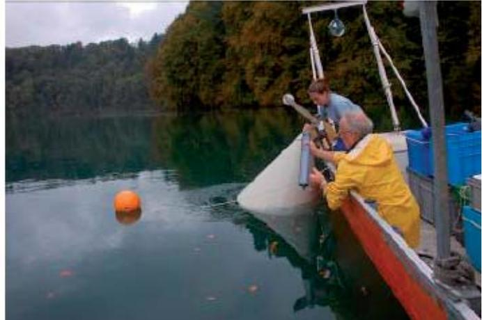
Mit trichterförmigen Gasfallen fangen Forschende der EAWAG das aufsteigende Methan auf, das vom Grund des Wohlensees emporsteigt.
