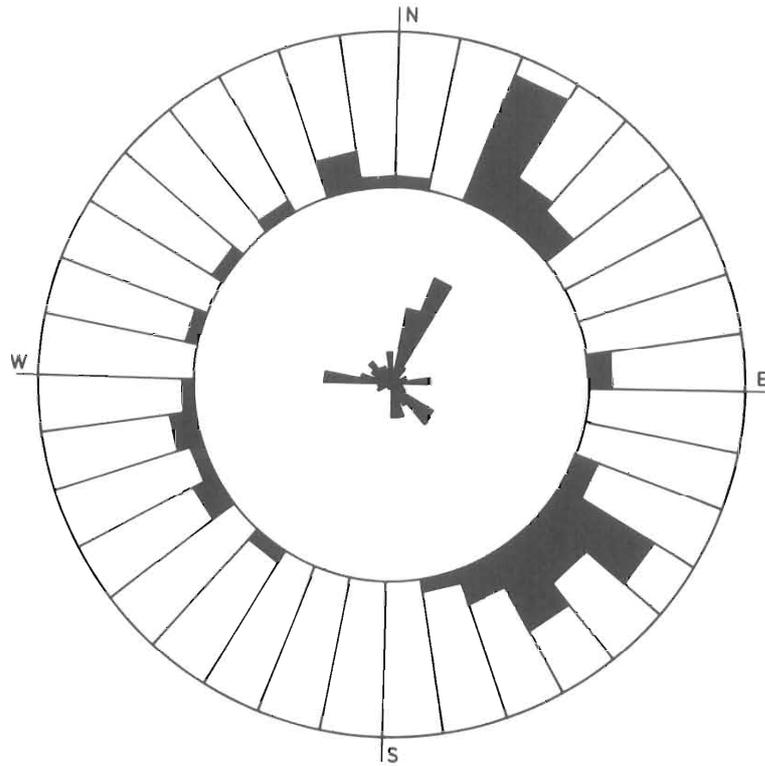
Fig. 2 Ergebnis einer Kluftmarkierung. In dem Ring ist die Häufigkeit der gefärbten Kluftflächen richtungsabhängig in % aller gefärbten Flächen aufgetragen (Innenkreis = 0 %, Außenkreis = 40 %). Ergänzend ist dazu die asymmetrische Gefügerose in der Segmentdarstellung wiedergegeben.
