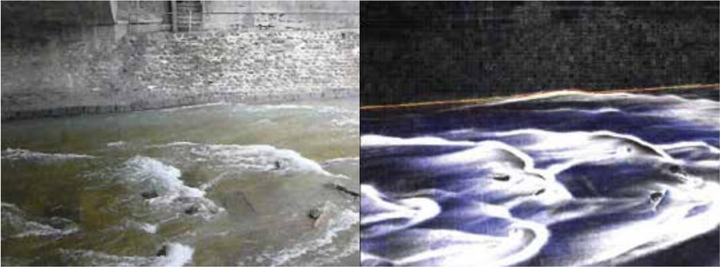
Die tiefe Bildauflösung schmälert die Aussage nicht: Nach der digitalen Bildverarbeitung kann der Wasserspiegel zuverlässig bestimmt werden.
