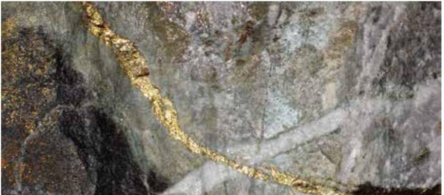
Feldbeobachtungen belegen die relative Zeitabfolge der Ereignisse: Eine kupferführende Ader (maximal ein Zentimeter breit) durchschneidet ältere Quarzadern (Gestein aus El Teniente, Chile). (Foto: ETH Zurich)
