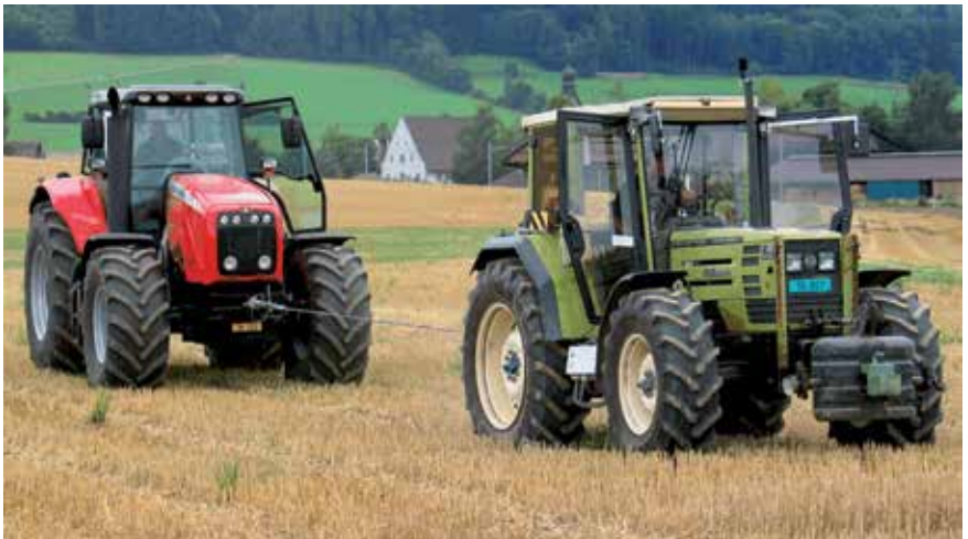
Tracteur tirant un autre tracteur: Cette configuration est utilisée pour créer du patinage au niveau des quatre roues de la machine tractant sur le site d'expérimentation un. (Photo: Abdallah Alaoui)
