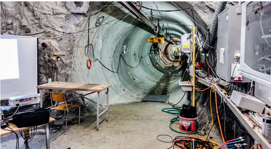
Abb. 6: Experiment zum stimulierten Aufbrechen des Kristallingesteins.
