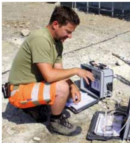
Probenahmen bei Sonde 20: Eine Probe vor Ort ergibt einen Methananteil von über 91 Prozent. (Foto: Oliver Sachs)
