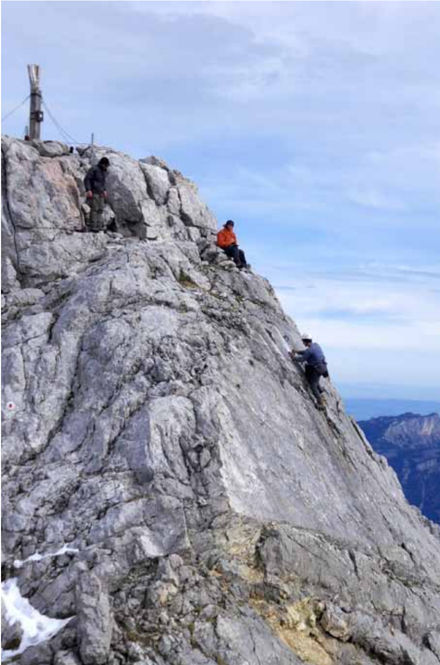
Temperaturmessungen im steilen Fels im Gipfelbereich des Hochkalters in Bayern: Die Resultate dieser Messungen sind für die Erstellung einer alpenweiten Karte mit Informationen zur potenziellen Verbreitung von Permafrost unerlässlich. (Foto: Matthias Rieckh)
