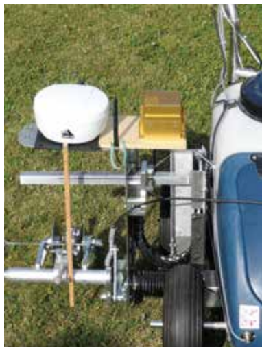
Abbildung 5: Links: Prototyp des in Abb. 4 gezeigten Linemarkers mit RTK GNSS Antenne (links), INS-Sensor (rechts) und Spritzdüse (unten). Zwischen beiden Sensoren sieht man die WIFI Antenne für den Datenaustausch mit der RTK-Basisstation. Oben: Auszug aus einer Messreihe für eine gerade Linie. Die Messwerte, aufgetragen in Ost- und Nordrichtung, zeigen die Bewegung des Linemarkers bei einer bewusst langsamen Fahrgeschwindigkeit von etwa 1 m/s. Die roten Punkte sind die GNSS Positionen (Taktrate 20 Hz) mit einer Streuung von etwa \pm 1-2 cm, mit denen die Linie markiert werden kann. Führt man sie jedoch zusammen mit den INS Messwerten einem Kalman-Algorithmus zu, wird die Lage der Spritzdüse gemäss der blauen Kurve geregelt mit einer Genauigkeit von nur wenigen mm. © Bild und Messdaten: Braunecker Engineering GmbH
