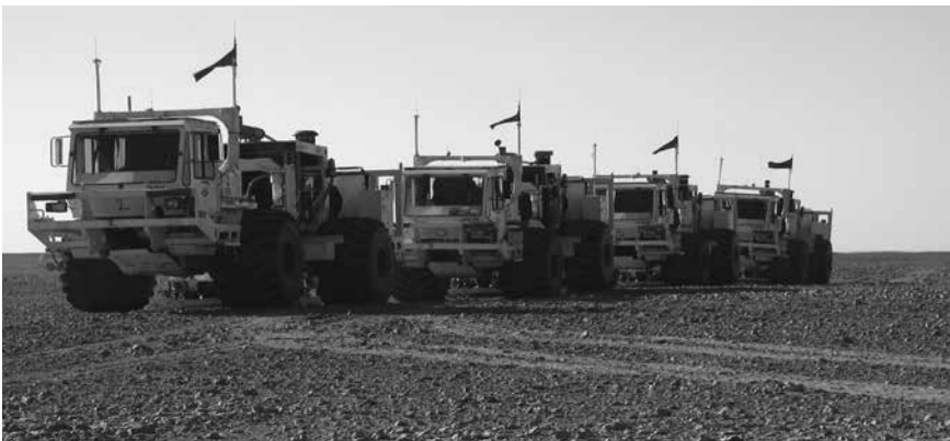
Ein solches Fahrzeug wiegt etwa 30 Tonnen: Die Kolosse pressen Stahlplatten gegen den Untergrund und erzeugen so die notwendigen Vibrationen, die später von den Geophonen registriert werden. (Bild: Felix Akeret)
