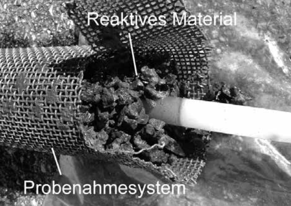
Reaktives Material im Probenahmesystem: Anhand einer Charakterisierung des Materials konnten die im System ablaufenden Prozesse beschrieben werden. (Bild: Bettina Flury)
