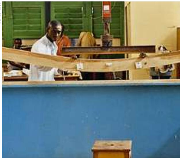
La poutre va-t-elle résister? Au Ghana, on teste des bois tropicaux pour construire des ponts.
