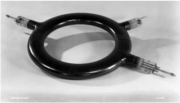
Fig 2: Elektronen-Kreisröhre aus Hartglas, das Herzstück des Betatrons.
