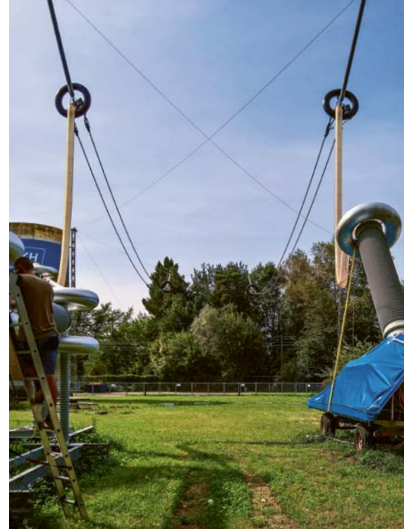
Sören Hedtke étudie les lignes électriques et les phénomènes de décharge, que ce soit à l'extérieur (ci-dessus), à l'intérieur sous un générateur de pluie (à droite) ou encore à l'aide d'un amplificateur de lumière ultraviolette (ci-dessous).
