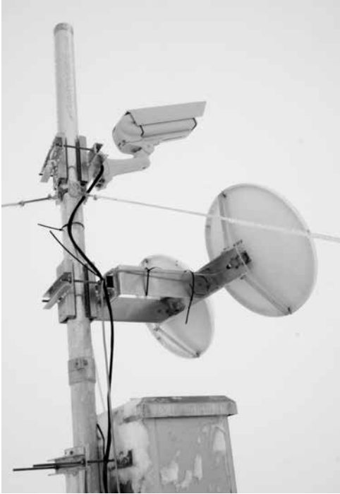
Lawinendetektionsradar: Durch den Doppler-Effekt werden Lawinen mittels Radar detektiert. (Bild: Daniel Lussi, SLF)
