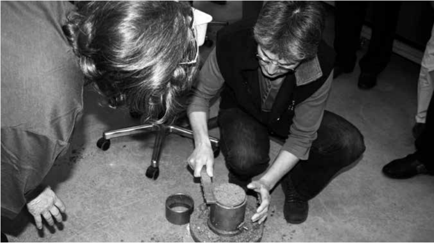
An der Eröffnung des Geozentrums Burgdorf werden die für die Praxis wichtigen Tests demonstriert: Franziska Nyffenegger (rechts), wissenschaftliche Mitarbeiterin am Geozentrum, zeigt den so genannten «Proktor-Versuch». (Bild: Berner Fachhochschule)
