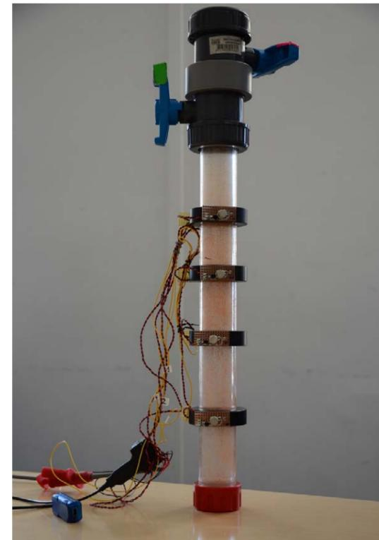
Sedimentation in einer Setzsäule: eine Wolke aus Sedimentpartikeln wandert durch eine Setzsäule. Die Bewegung wird dabei von vier in den Ringen installierten Photometern festgehalten. Das Gerät wurde an der Uni Basel entwickelt. Ausgangspunkt war die Notwendigkeit in 20 Sekunden während eines Parabellflugs eine Messung durchzuführen. Ein Nebeneffekt: das Gerät verkürzt nun auch die Messdauer von ca. einer Stunde auf eine Minute auf der Erde.
