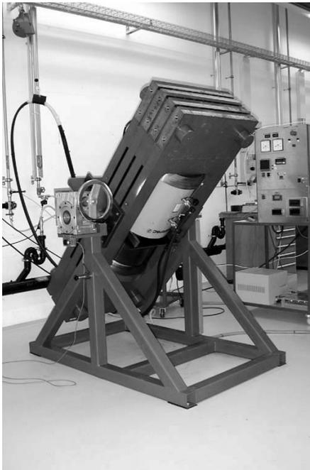
Mit der schwenkbaren 600 Tonnen Multi-Anvil Apparatur können Drücke bis 250 kbar und Temperaturen bis 2500°C erreicht werden. Mit dem Schwenken wird verhindert, dass sich die fluide von der festen Phase trennt (Bild: Peter Ulmer).
