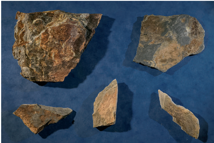
Abb. 25: Erzproben der Stellen TA12-22 (links oben), TA12-6 (rechts oben) und TA11-9 (die drei Stücke unten). Die Messwerte mit dem GM-Zähler direkt auf den Schiefnern betragen 0.13 mSv/h bis 0.25 mSv/h, die Urangelhalte 0.7 bis 1.9 Gewichtsprozent. Die Zählraten an den Fundstellen TA12-22 und TA11-9 ergaben über 150 kcps für den Szintillationszähler. Bildbreite 25 cm.
