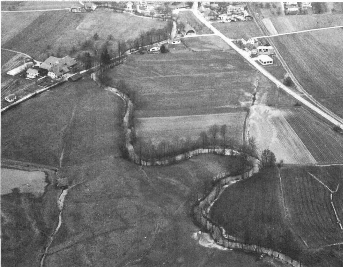
Abb. 39 Kleindietwil. Langete und Wassergebiete oberhalb des Dorfes mit Überschwemmungsercheinungen, geflogen einen Tag nach dem ausserordentlichen Hochwasser vom 22./23. November 1972. Sehr gute Durchlässigkeit der Wässermatten-Schotterböden, die am Vortag noch schuhtief unter Wasser lagen. Aufn. Verfasser
