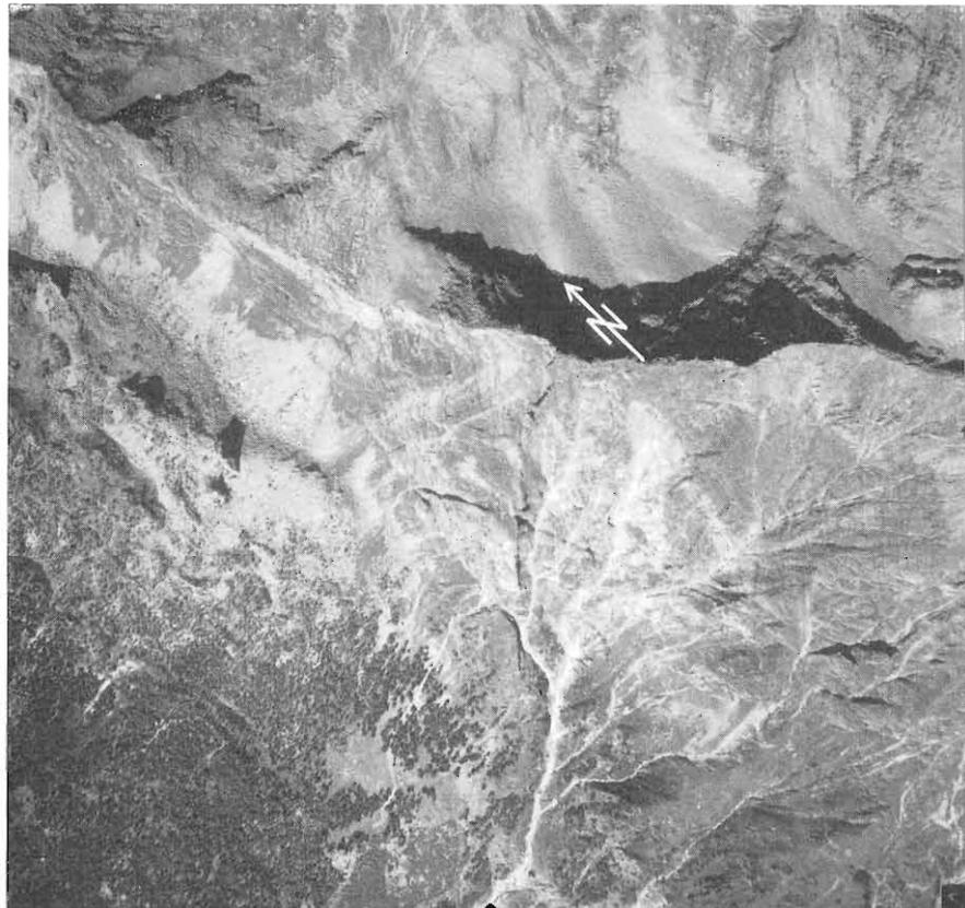
Luftaufnahme Eidg. Vermessungsdirektion: Östlicher Teil der Sakkung von Fontana (links) und Südwestwand des P. delle Streghe (Mitte rechts). Der im Anstehenden erkennbare Bruch streicht in ESE-Richtung. In der Südwand des P. delle Streghe läßt er sich nicht durchgehend verfolgen; erst östlich davon, an der Wasserscheide gegen Val Calanca, tritt er wieder deutlich hervor.
