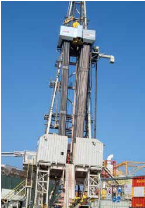
Bohrturm in Basel: Die Fracking-Methode wird bei einem Geothermieprojekt eingesetzt. (Bild: Geothermal Explorers Ltd)
