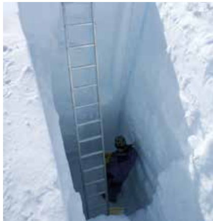
Vier Meter in die Tiefe: Die Forschenden entnehmen dem Schneeschacht grosse Firnblöcke für die anschließende Tomografie.
