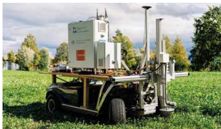
Prototyp des Robotiksystems zur Bekämpfung von Unkraut auf landwirtschaftlichen Nutzflächen.
