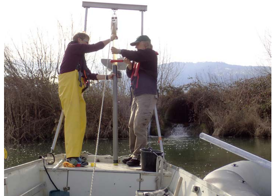
Feldarbeit zum ersten: Forscher bergen einen Sedimentkern aus dem Zürichsee (Obersee). (Bild: Nathalie Dubois) | Les scientifiques prélèvent une carotte de sédiment dans le lac de Zurich.
