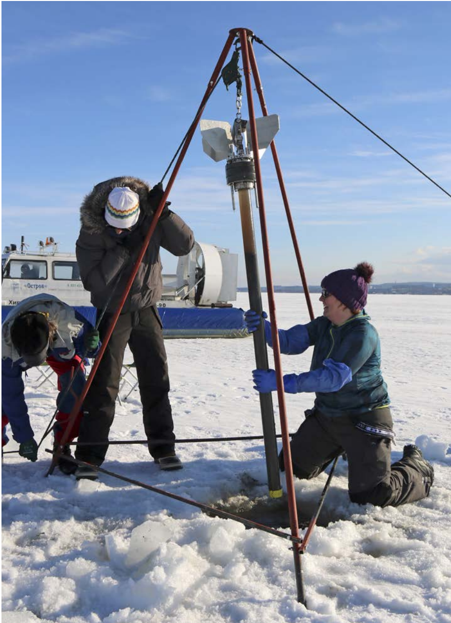
Feldarbeit zum zweiten: Auf dem zugefrorenen Onego-See in Russland konnten die Forscher mit Dreibein, Gravity-Corer und viel Einsatz zahlreiche Sedimentkerne ziehen. (Bild: Mischa Haas) | Avec un trépied, un carottier gravitaire et beaucoup d'efficacité, les chercheurs arrivent à prélever de nombreuses carottes de sédiment dans le lac gelé d'Onego en Russie.
