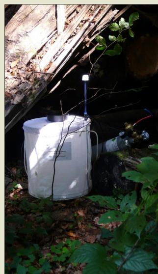
Die weisse BG Sentinel Falle ist ausgestattet mit einem Lockstoff, ausströmendem CO<sub>2</sub> und einem Ventilator.
