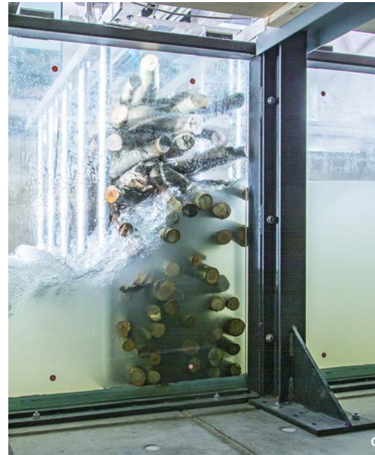
je höher der Anteil Feinmaterial in einer Schwemmholzverkläung (b und d). Fliessrichtung von rechts nach links. (Bilder: VAW) | flotant (c et d) et de la proportion de matériau fin (b et d). L'écoulement se fait de droite à gauche.
