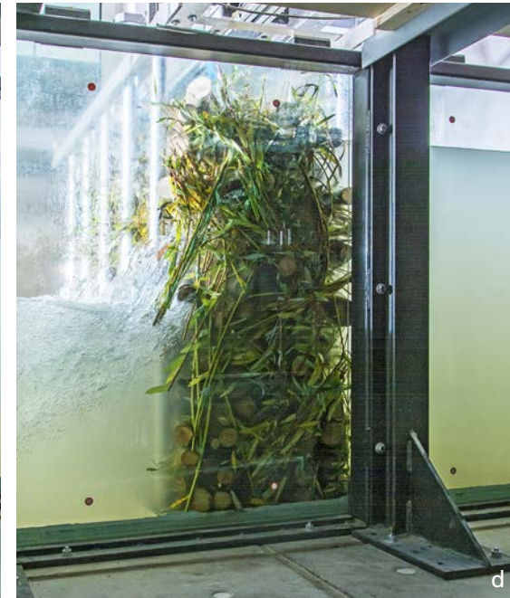
je höher der Anteil Feinmaterial in einer Schwemmholzverkläung (b und d). Fliessrichtung von rechts nach links. (Bilder: VAW) | flotant (c et d) et de la proportion de matériau fin (b et d). L'écoulement se fait de droite à gauche.
