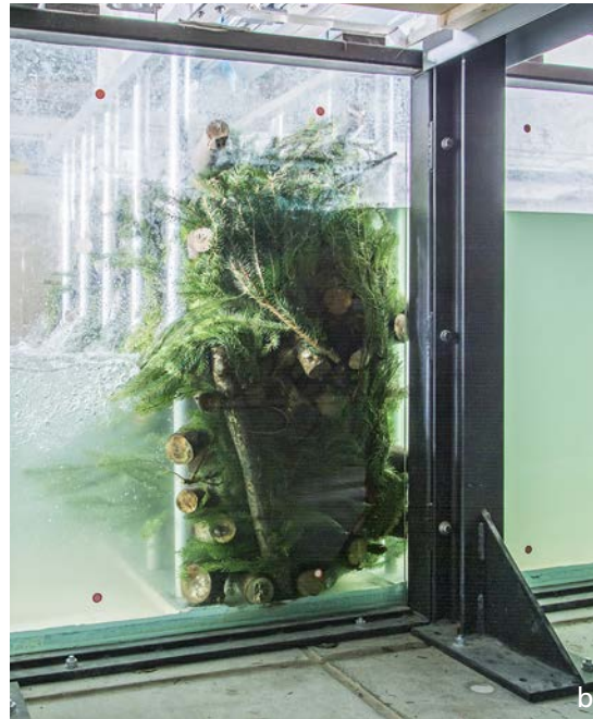
Tests im Massstab 1:6 im Versuchskanal an der VAW: Die Aufstauhöhe ist umso grösser, je dichter das Schwemmholz-Paket (c und d) und Tests à l'échelle 1/6 dans le canal d'expérimentation du VAW: la hauteur de la retenue varie en fonction de la densité de la masse de bois
