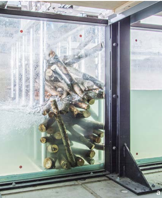
Tests im Massstab 1:6 im Versuchskanal an der VAW: Die Aufstauhöhe ist umso grösser, je dichter das Schwemmholz-Paket (c und d) und Tests à l'échelle 1/6 dans le canal d'expérimentation du VAW: la hauteur de la retenue varie en fonction de la densité de la masse de bois
