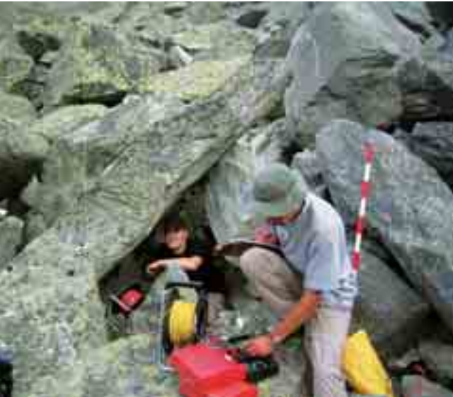
Campagne de mesures géoélectriques sur un glacier rocheux
