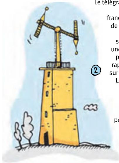
Le télégraphe prend son essor durant la Révolution française, grâce au travail de Claude Chappe. Basé sur le principe du sémaphore de marine, une succession de tours permet de transmettre rapidement des signaux sur une grande distance. L'opérateur d'une tour réplique le signal observé sur la tour précédente. Un code associe chaque position du sémaphore à un mot, une phrase ou une expression. Seules les extrémités de la ligne en détiennent la clé.
